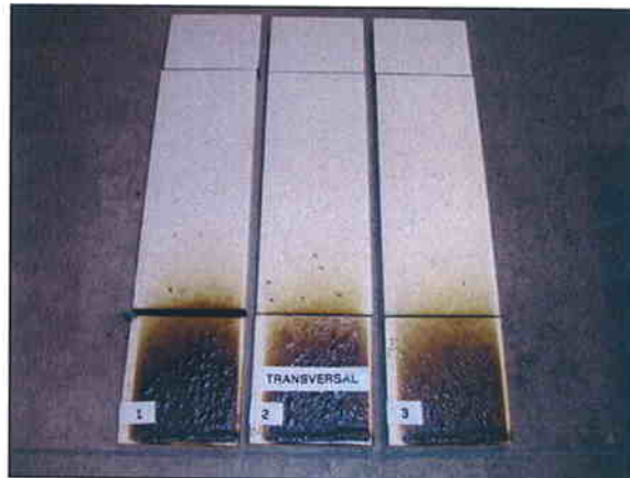
Foto nº3: Aspecto de la zona afectada por la radiación de las 3 muestras ensayadas
